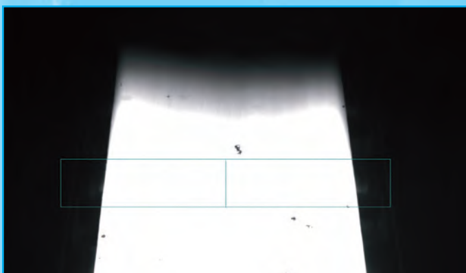
Kamerabild und relevanter Messbereich von hotCAM in der Fertigstraße
