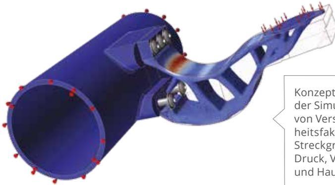
Konzeptvalidierung anhand der Simulationsergebnisse von Verschiebung, Sicherheitsfaktor, Prozent der Streckgrenze, Zug und Druck, Von-Mises-Spannung und Hauptnormalspannung.
