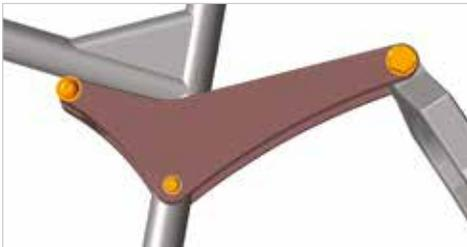
Verbinden Sie mehrere Komponenten mithilfe von Befestigungselementen (Bolzen und Schrauben) und Verbindungselementen (Zapfen und Gleitzapfen), um Baugruppen realistisch zu modellieren. Im Anschluss können Analysen und Optimierungen durchgeführt werden.
