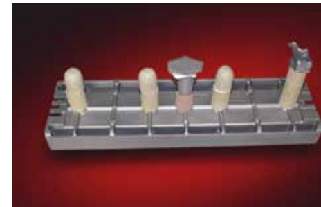
Bild 2: Sandgussteil (Gewicht 31,5 kg) gegossen mit einem KALPUR AL Einsatz. Steigerung des Ausbringens auf 75%
