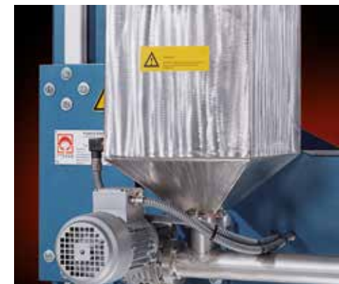
Schneckenförderer für präzise und reproduzierbare Zugabe
