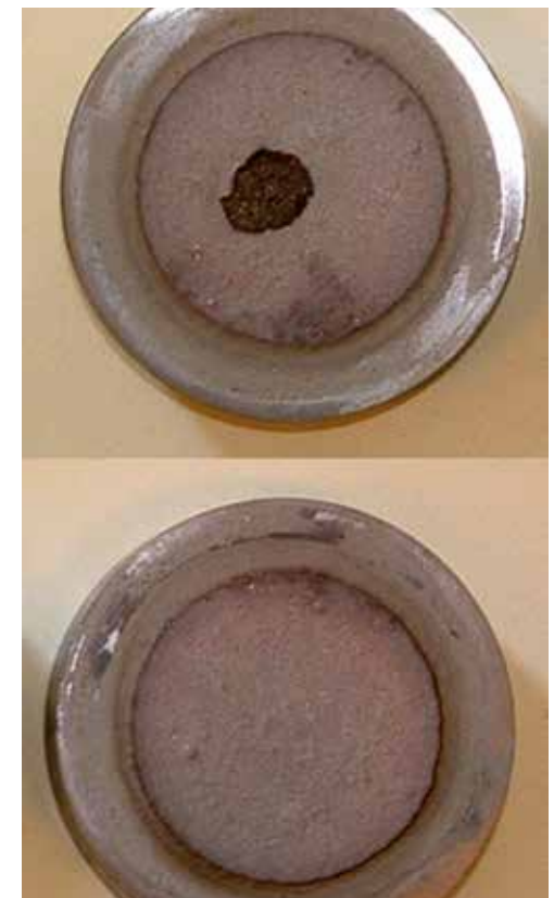
Bild 5 Oben: Schülpenbildung bei Verwendung einer Standardschlichte mit geringer Gasdurchlässigkeit, darunter: keine Schülpenbildung bei Verwendung von RHEOTEC XL+ Schlichte
