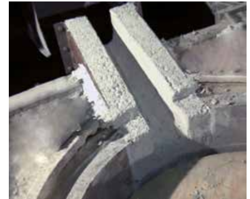
BLU-RAM HS formbare Materialien zum Auskleiden der Schnauze
