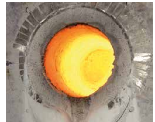
Gesinterte Auskleidung mit KELLUNDITE Trockenstampfmasse
