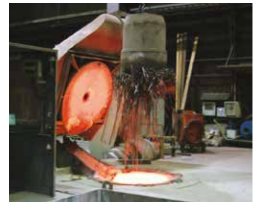
Großer Induktionstiegelofen 35 t beim Einschmelzen
