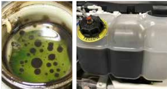
Verunreinigungen im Kühlkreislauf
