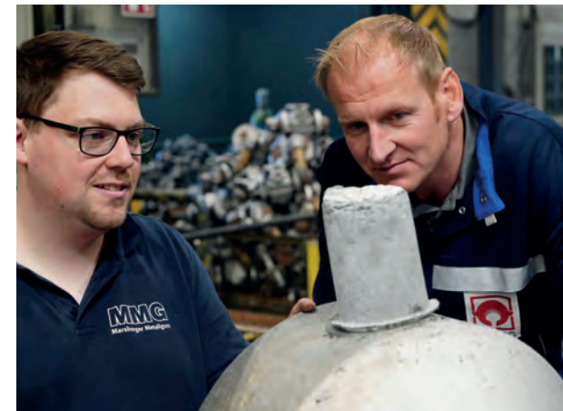
Speiser nach dem Abguss bereit zum Abschlagen
