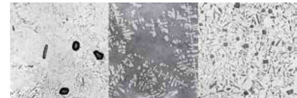
Unterschiedliches Veredelungsgefüge einer AlSi-Legierung
