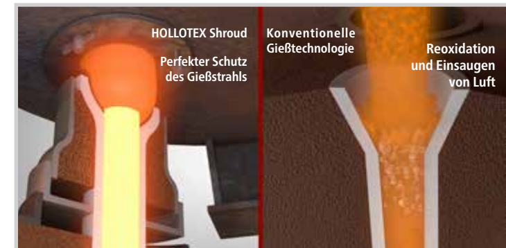
Vergleich von HOLLOTEX Shroud und konventioneller Gießtechnologie
