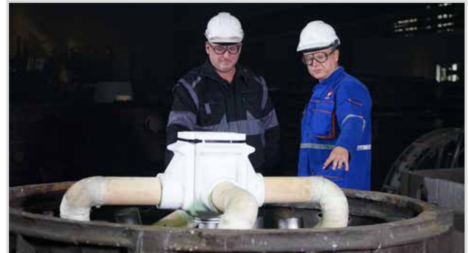
HOLLOTEX Shroud Filter Box während der Formherstellung
