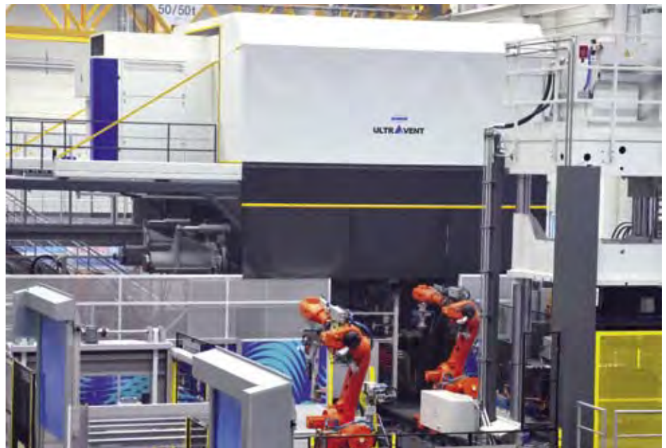
Die Erfassungshaube direkt über der Druckgussmaschine erfasst den Rauch und Aerosolnebel. Im Anschluss erfolgt über den Ultravent-Elektrofilter (links neben der Haube) die energieeffiziente Abluftreinigung. / The extraction hood captures the smoke and aerosol mist directly above the die casting machine. The energy-efficient treatment of the exhaust air then takes place via the Ultravent electrostatic precipitator (to the left of the hood).
